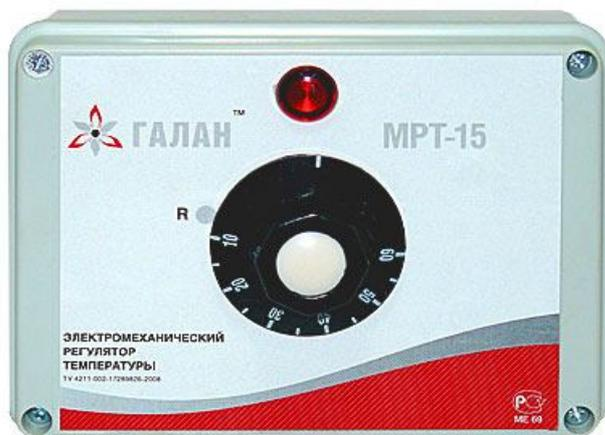
Электромеханический регулятор температур «МРТ-15» предназначен для поддержания заданного теплового режима работы электрических водонагревателей до 6 кВт на 220V или до 15 кВт на 380V. Регулирование температуры осуществляется в диапазоне от 10° до 60° C по температуре обратной трубы. Канал защиты от перегрева обеспечивает отключение нагрева при достижении температуры падающей трубы примерно 90° C.
